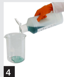
4 Inhalt des Dosierkopfs ausgießen
